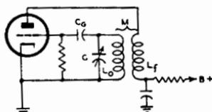
FIG. 24.3 TUNED-GRID OSCILLATOR
