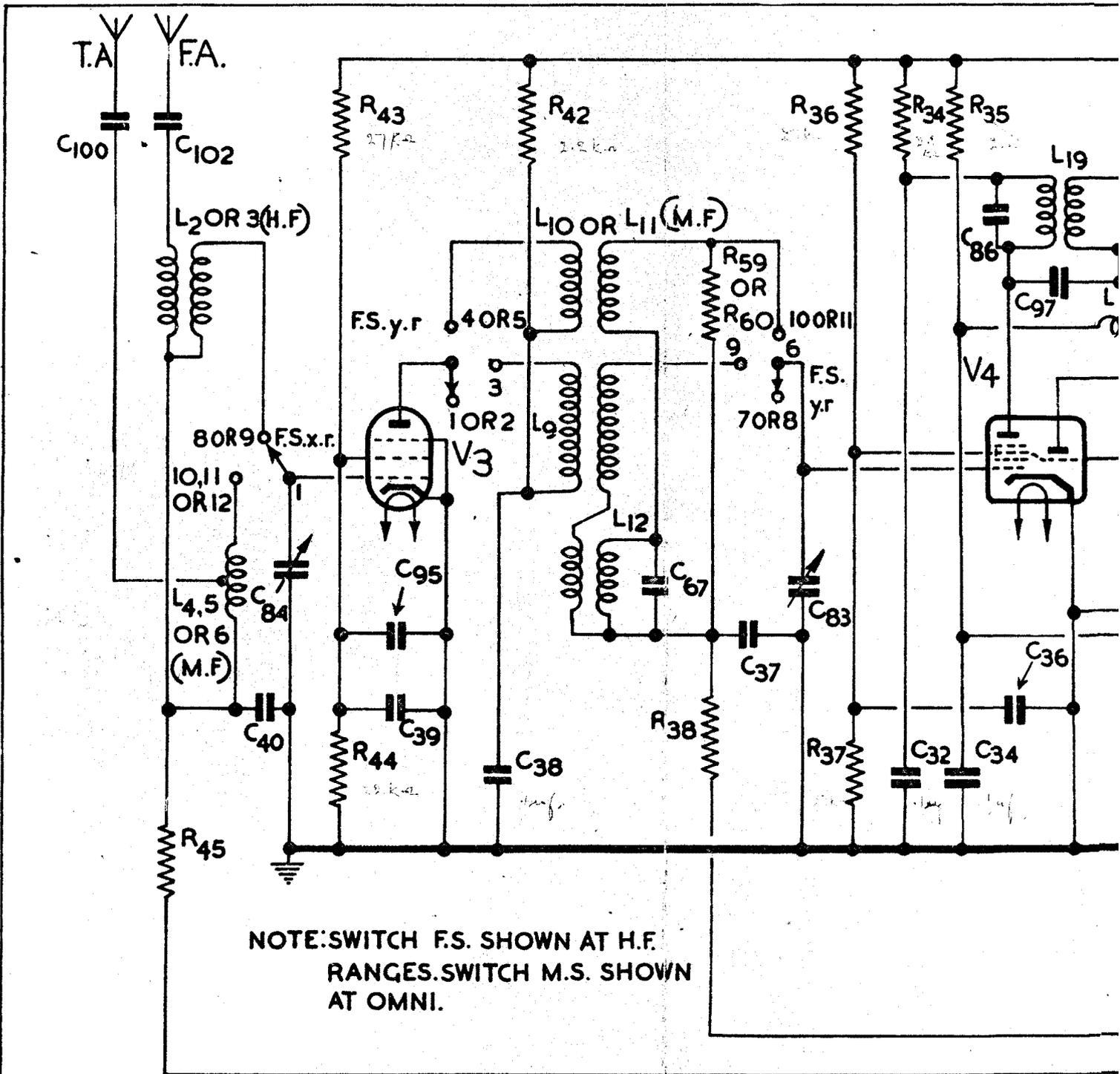
NOTE: SWITCH F.S. SHOWN AT H.F. RANGES. SWITCH M.S. SHOWN AT OMNI.
