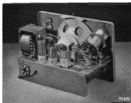
Binnenaanzicht van de „signal tracer”. Let op de Rimlock buizen en de bellende stand van de kathodestraalindicator.
