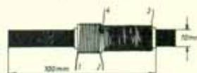
Fig. 3. FERRIETSTAAF 10 mm Ø 100 mm lang. Gewikkeld op kartonnen kokertje: L1 10 wdg e.z. 0,35 mm Ø; L-2 50 wdg litze 20 x 0,05 of 36 x 0,07.
